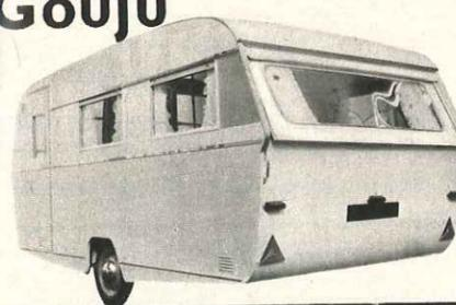
Châssis et caisse monocoque rigide avec double plancher isothermique. Double paroi avec isolant et vide d'air.
